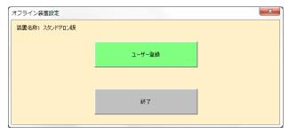
装置一覧画面で対象の装置をダブルクリックするか、「装置詳細」ボタンを押すと、ユーザー登録画面に入る画面が表示されますので、「ユーザー登録」ボタンを押すと、ユーザーの登録画面が表示されます。
