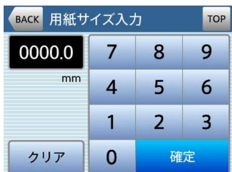
④ テンキーで用紙の全長を入力し、「確定」キーを押します。(単位mm)
