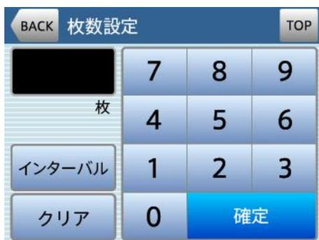
② テンキーを使って折りたい枚数をカウンタに入力し、「確定」キーを押します。
