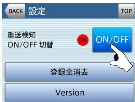
② 重送検知のON/OFFは、設定画面の「ON/OFF」キーを押すことで切り換えができます。
