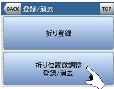
② 「折り位置微調整 登録/消去」キーを押して、折り位置微調整登録/消去画面に移動します。
