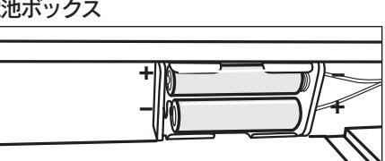
付属の単3形乾電池2個をテーブル裏側の側面にある電池ボックスにセットしてください。
