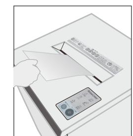
※投入口に細断物が多く入った場合、投入口自動開閉機構が働き「細断可」ランプが点滅します。
