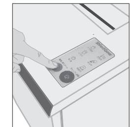
※最初に「電源/再スタート」スイッチを押した時に投入口に細断物等が置かれていますと「停止中」ランプが点滅します。細断物を取り除き、再度「電源/再スタート」スイッチを押してください。
