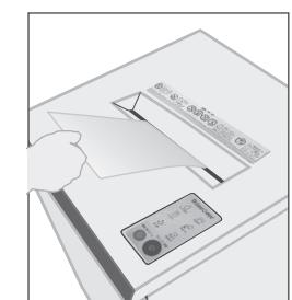
③ 細断を途中で止めるときは「ストップ/逆転」スイッチを押してください。このとき投入した細断物が見えなくなつていれば1-①の表示に戻ります。
